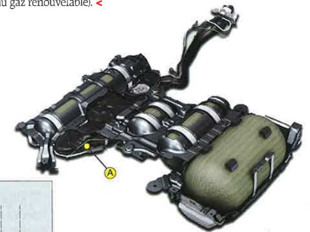
Fig. 5. Le module de réservoir de l'Audi A4 g-tron avec le réservoir d'essence (A) et les réservoirs de gaz.
