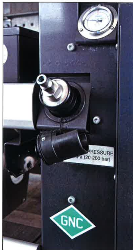
Cet adaptateur permet de faire le plein auprès d'une station-service réservée aux voitures.
