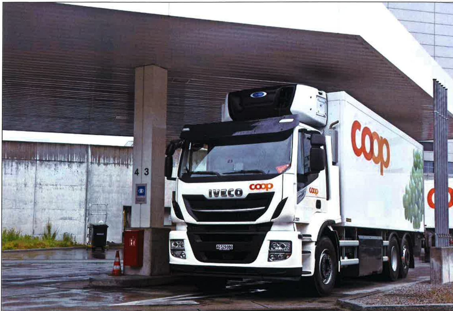
Une véritable alternative au diesel: cet IVECO de 13 litres et de 400 ch roule au gaz naturel et au biogaz. Coop l'utilise pour ses transports régionaux.
