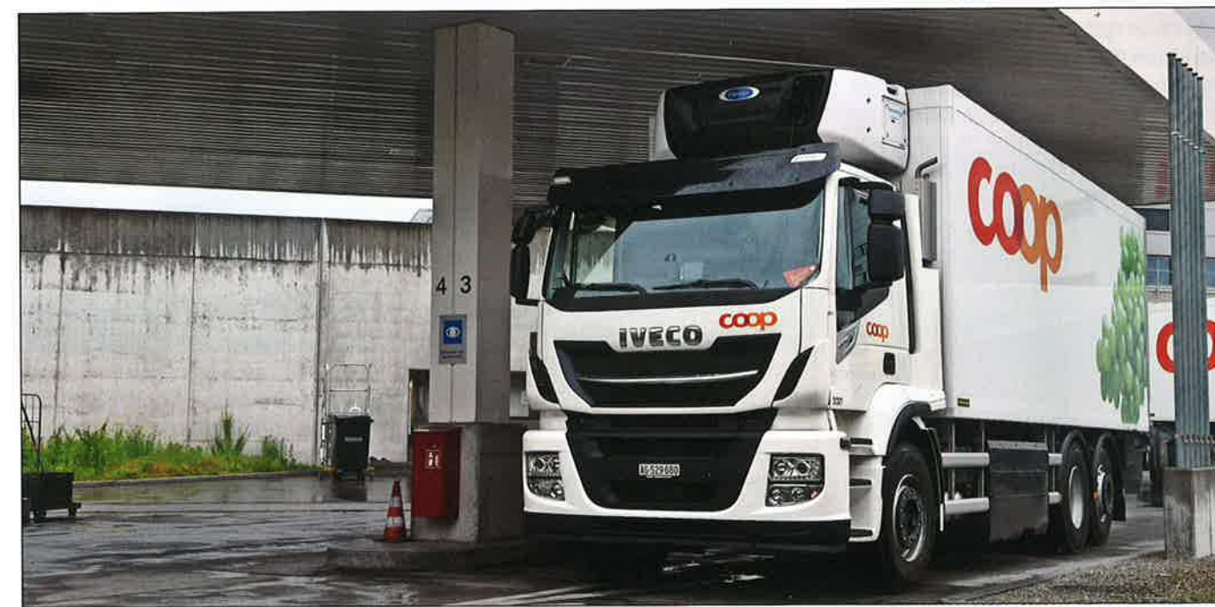
Un Iveco fonctionnant au gaz: plusieurs entreprises, comme ici Coop, possèdent déjà dans leur flotte de véhicules des camions qui sont alimentés au gaz, qu'il s'agisse de gaz naturel comprimé (GNC) ou de gaz naturel liquéfié (GNL).
