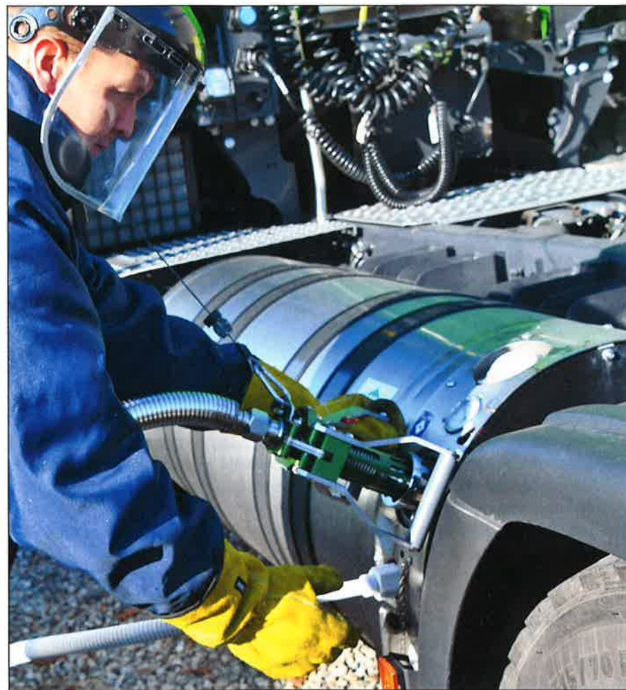
Le remplissage d'un camion fonctionnant avec du GNL: l'utilisation du gaz naturel liquide constitue une variante possible pour une motorisation à faible taux d'émissions nocives.
